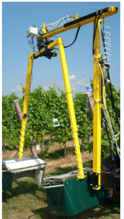
In presenza di giovani viti in impianti adulti può essere montato un dispositivo di apertura che permette di divaricare le due semimetà della macchina con comando idraulico da parte dell'operatore, allontanando le spazzole da piante di piccole dimensioni ed interrompendo la spruzzatura del liquido spollonante.
